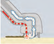
Limpieza, aspiración con vapor y aspiración en seco en sólo un paso
